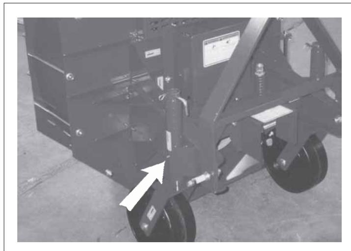
Fig. 24 GAGE WHEEL CASTER SHAFT
