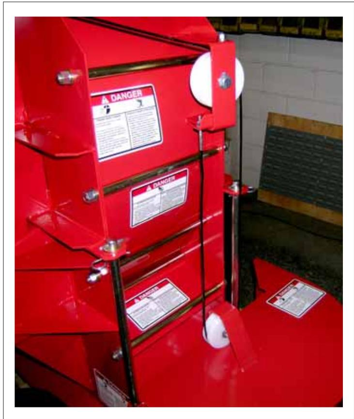
**Fig. 6 CABLE/PULLEYS**
