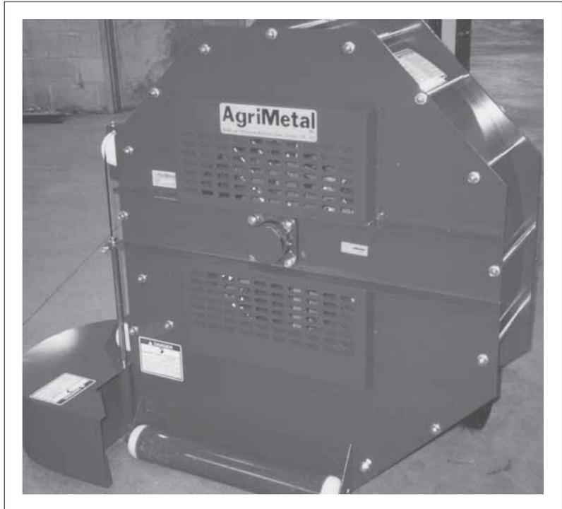
Fig. 20 INTAKE GUARDS (TYPICAL)
