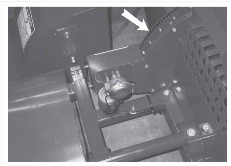
**Fig. 29 DUCT POSITION ROLLER CHAIN**
