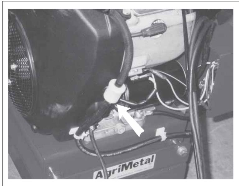
**Fig. 28 IN LINE FUEL FILTER**
