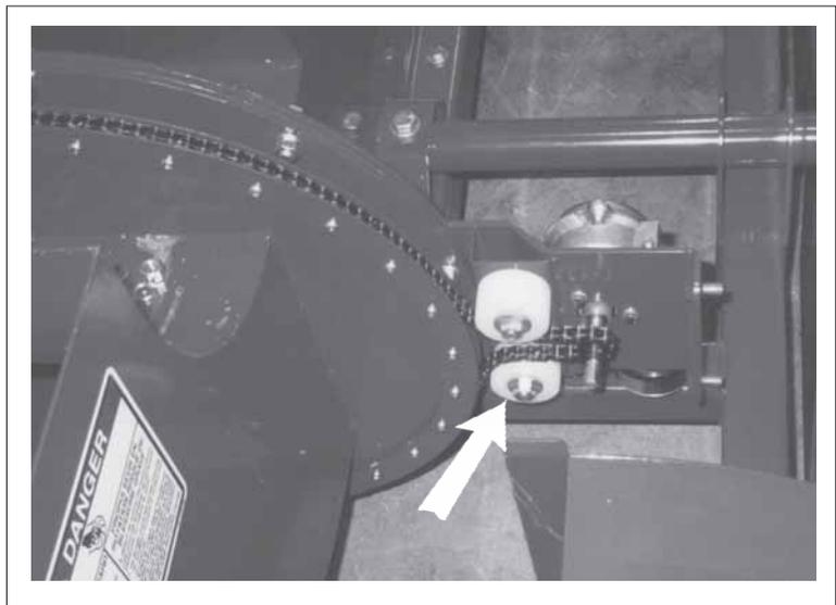
Fig. 35 IDLER SPROCKET
