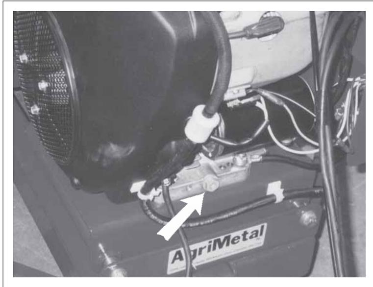
Fig. 25 ENGINE DRAIN PLUG
