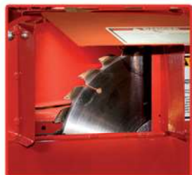
Lame au carbure pour une plus grande durabilité.
