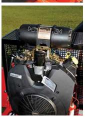
◆ THE AGRIMETAL TURBINE BLOWER IS POWERED BY A KOHLER 38HP COMMAND PRO GAS ENGINE, TO PRO-VIDE AMPLE TORQUE AND POWER FOR THE HIGHEST PERFORMANCE ON THE MARKET.
