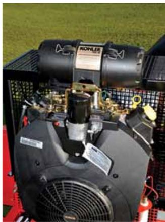
◀ **LA TURBINE TB-380 I.C. EST ACTIONNÉE PAR UN MOTEUR À ESSENCE KOHLER 38 CV COMMAND PRO.**
