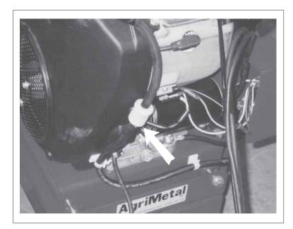
Fig. 28 IN LINE FUEL FILTER
