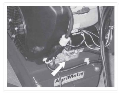
Fig. 25 ENGINE DRAIN PLUG
