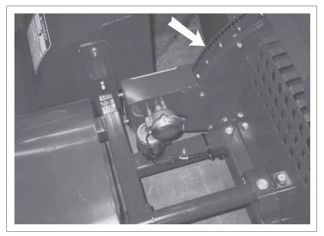
Fig. 29 DUCT POSITION ROLLER CHAIN
