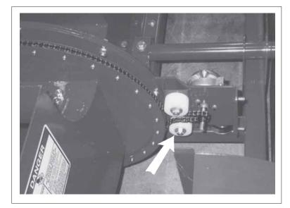
Fig. 35 IDLER SPROCKET
