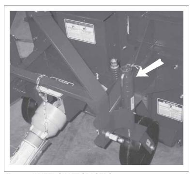
Fig. 18 WHEEL SHAFT SPACERS
