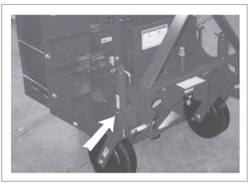
Fig. 24 GAGE WHEEL CASTER SHAFT
