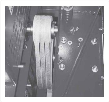
Fig. 29 BELT ALIGNMENT (TYPICAL)
